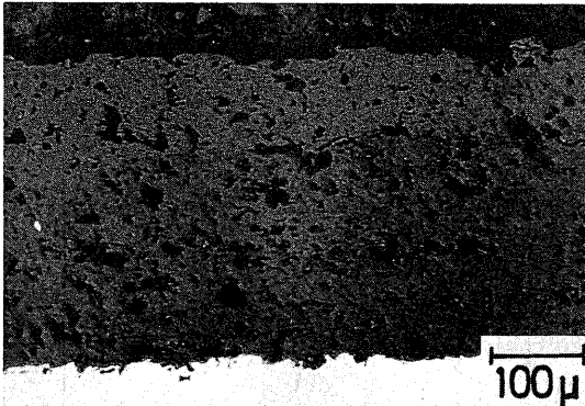
図-17 多孔質アルミナ溶射皮膜の断面写真
