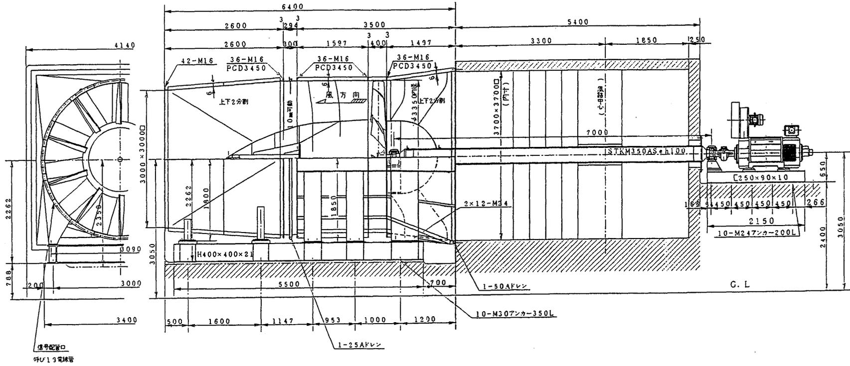
図4 送風機・電動機系組立図
