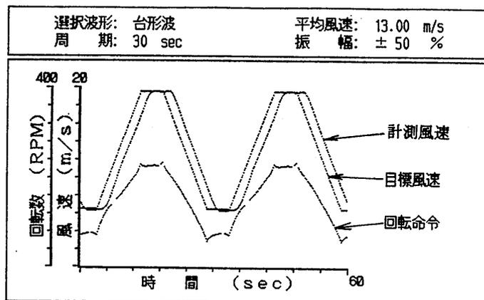
図23-k 発生させた台形波変動風の例(13m/s, 30s)
