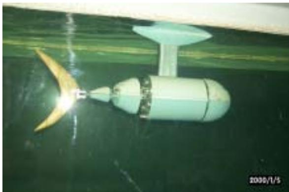
図 3.3 推進性能実験用魚ロボットの外観
