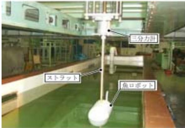
図 3.10 曳航実験装置の外観
