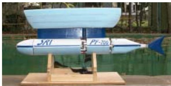
図 5.2 直流モータを使用した実験用魚口ボットの外観
