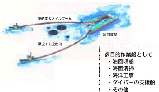
図1 流出油回収システムの概念図
