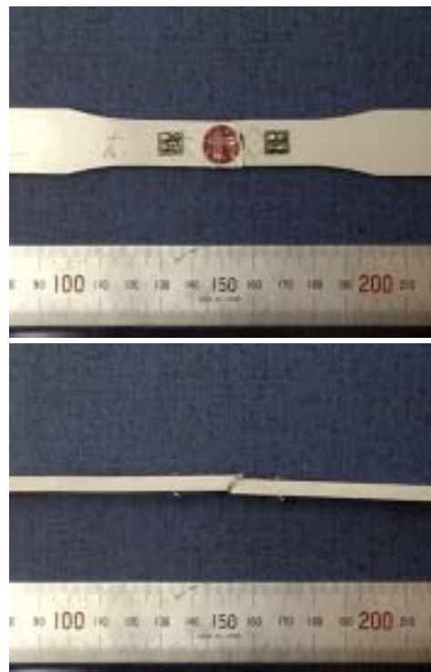
図 - 2.4 引張試験片破壊状況
