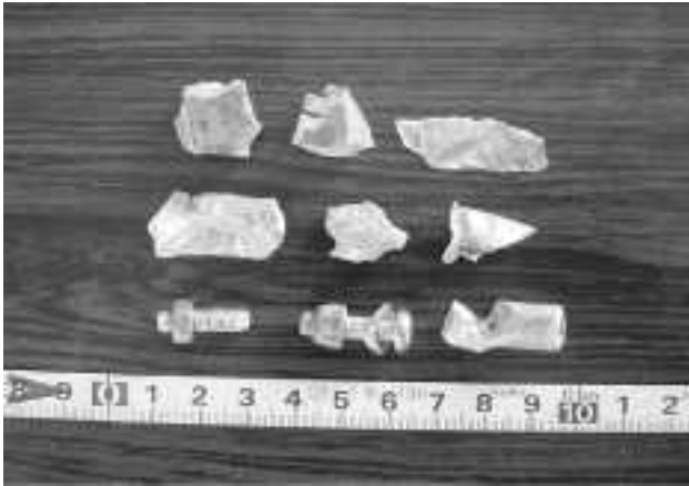
Fig.4.3.3 分別機から採取した金属片
