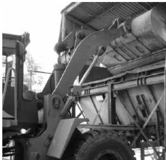
Fig.4.4.7 混合物のホッパーへの投入
