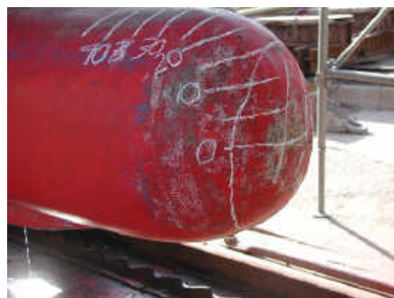
図 - 24 バルブスバウの損傷部
