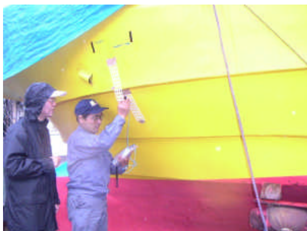
図 - 26 実用機による劣化診断の様子 (実習船)
