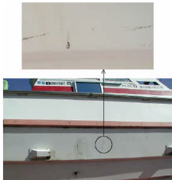
図 - 23 漁船における剥離損傷周辺の測定部
