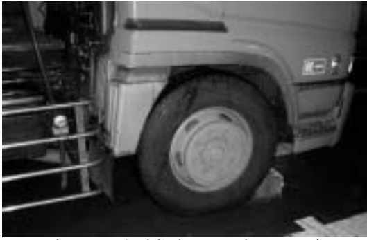
写真 C.9 非危険物車両の固定（クサビ）
