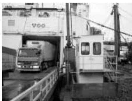
写真 C.5 下層車両甲板の荷役 （東予。船尾ランプウェイ）
