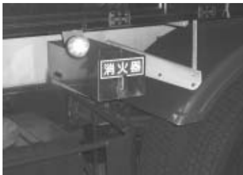
写真 C.34 タンクローリーの消火器
