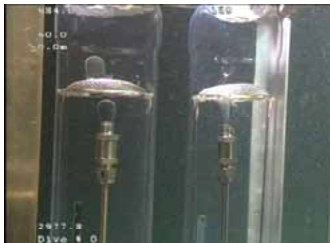
図-43 深度 500m におけるハイドレート核生成実験の様子
