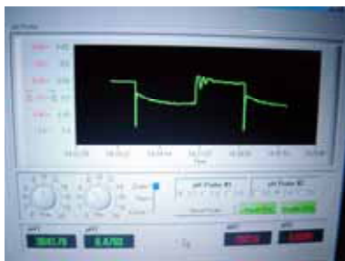
図-40 実海域実験において HCl 溶解海水を希釈した場合のデータ収録装置のモニター画面の例
