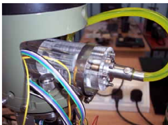
図-64 オイルが封入された光学ガラスファイバー管を取り付けた高耐圧フローセル
