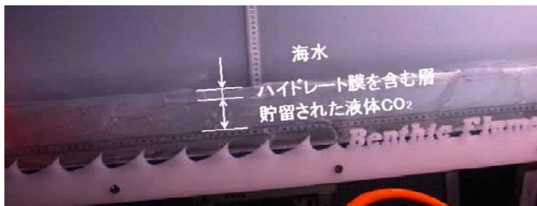
図-32 2 回目の本実験において、自然条件下で 2 昼夜放置した後の海底水路内の CO 2 の様子
