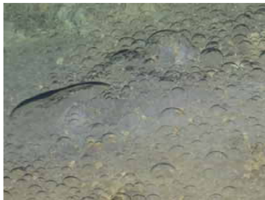
図-50 深度 3000m の深海底に溜まったさまざまな寸法の CO 2 液泡
