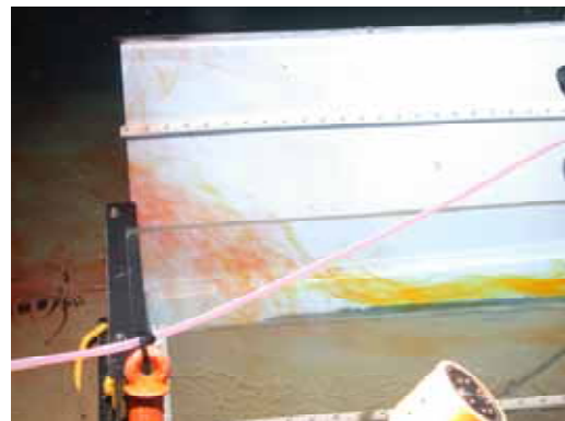
図-33 pH 依存発色染料による密度成層の確認実験の様子
