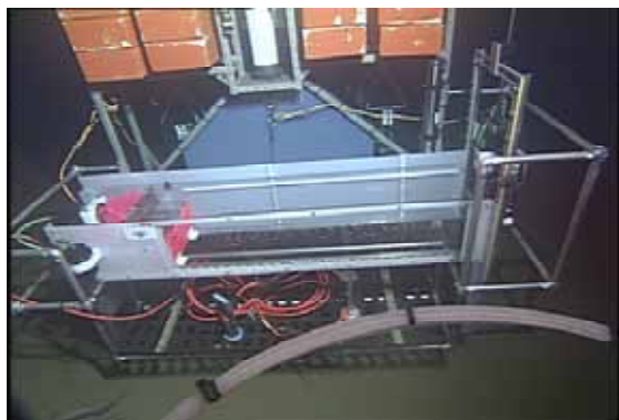
図-11 第2回本実験で使用した改良型海底水路
