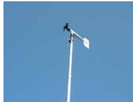
写真 3.1.4 ヤング風向風速計
