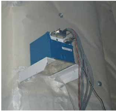
写真 3.1.5 FOG 姿勢計測装置
