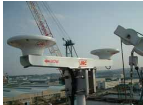
写真 3.1.7 方位・位置計測機
