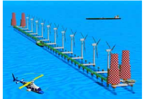
図-3.19 国立環境研究所の非係留帆走型風力発電方式の概念図
