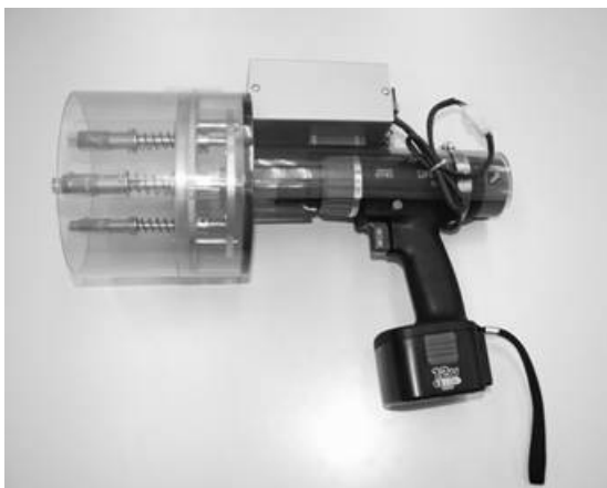
図3-8 小型軽量化した試料採取装置(左)、ハンドドリルをベースに電源を一体化し、かつ片手で操作できる。船底からの採取の様子(右)。
