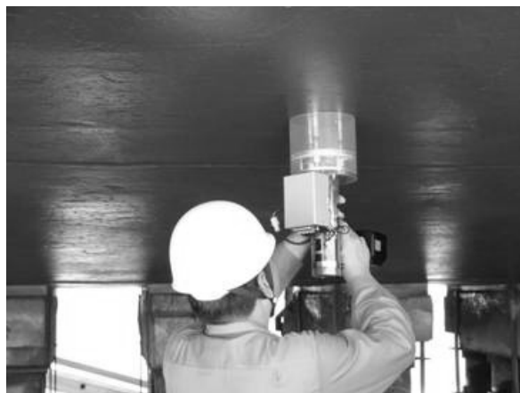
図3-8 小型軽量化した試料採取装置(左)、ハンドドリルをベースに電源を一体化し、かつ片手で操作できる。船底からの採取の様子(右)。
