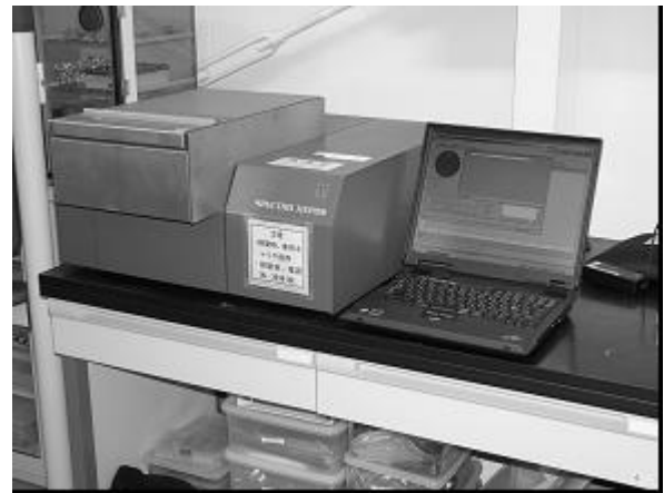
図 4-5 塗料検査装置の外観:本体(左)及び制御用コンピュータ(右)
