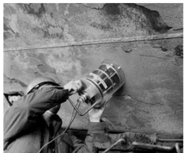
図 3-5 実船による試料採取の実地試験
