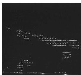
図 3-38 (1) 撮影画像の PIV 解析結果 (L1 断面、 \lambda/L=1.25 、Camera1、前方配置)
