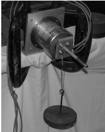
写真 4-1 検定中のロードセル
