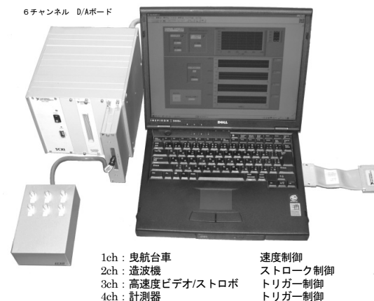
図 3-11 自動制御システム
