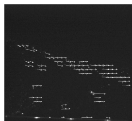
図 3-38 (1) 撮影画像の PIV 解析結果 (L1 断面、 \lambda/L=1.25 、Camera1、前方配置)
