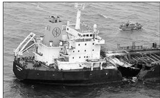
写真-1 衝突されたダブルハルタンカー”Baltic Carrier”
