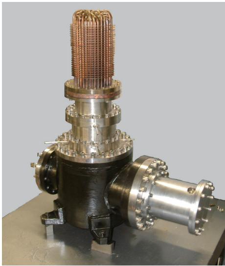
図 3.19 スターリングエンジン 3 号機の外観
