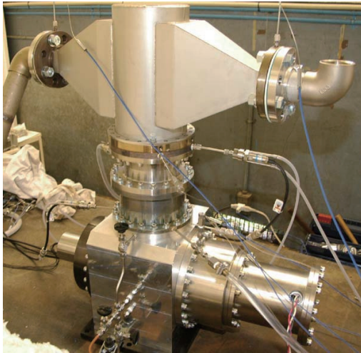
図 3.7 スターリングエンジン 1 号機の外観
