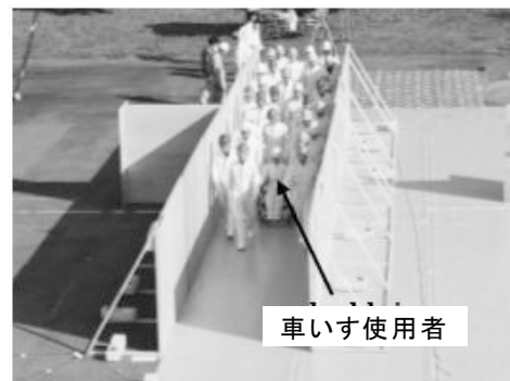
図 4-4 実験の様子 (通路幅 2m)
