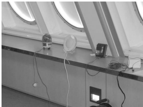
図 3-28 使用した閃光ライト(左からパトライト, 光るチャイム, ストロボライト)
