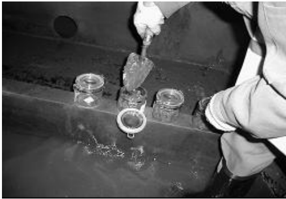
図-18 沈殿物の採集 (5mm 程度以下の厚さのところが多く、厚いところで 10mm 程度であった。)
