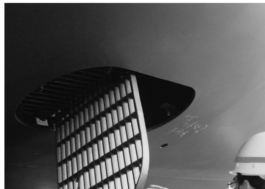
図-10 シーチェスト（ここから海水を吸い込む。内部は大きなタンクになっている。5 万トンバルカー）
