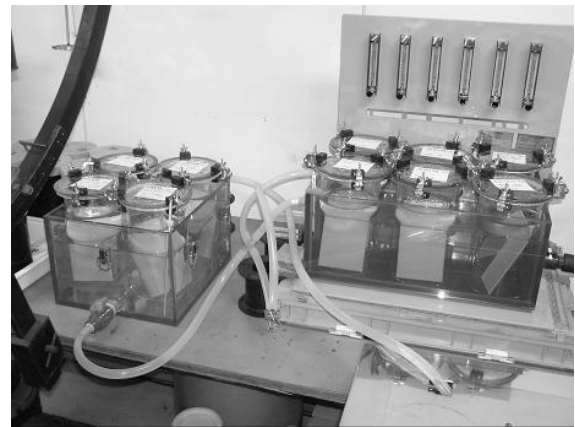
図-42 密閉容器浸漬試験状況
