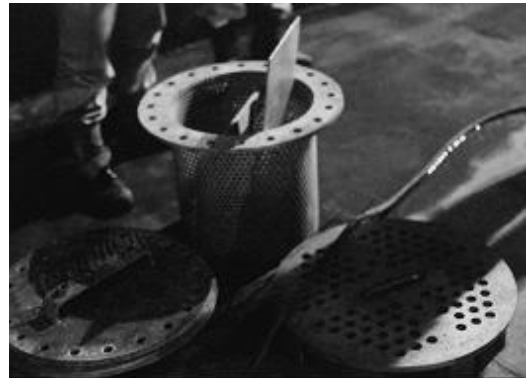
図-11 ストレーナー（海水はストレーナーを通してポンプへ）
