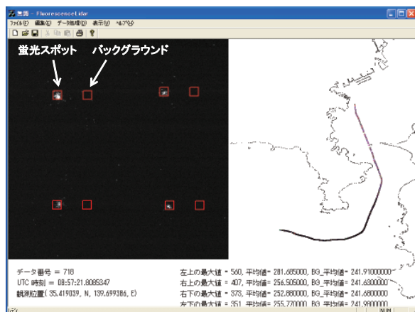
図-2.14 濁り・汚染マップ表示画面 (左：RGB 値算出画面、右：マップ／飛行航路)
