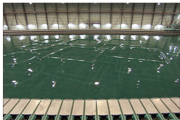
図-5.15 任意波の造波例 (文字造波、海上技術安全研究所ロゴマーク)
