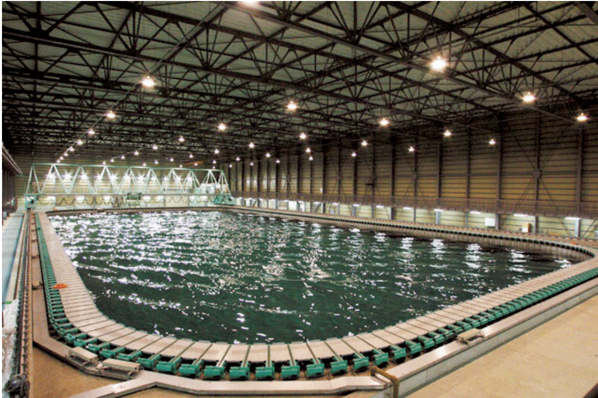
図－1.2 短波頂不規則波を発生中の実海域再現水槽
