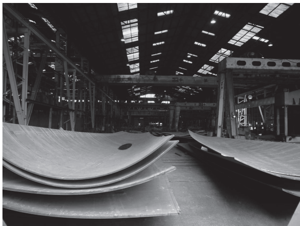
図-19 造船工場における加工済み部材の 集積管理状況
