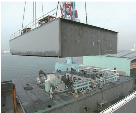
図-6.5 上部ブロック搭載までに艤装品搭載を完了させる例
