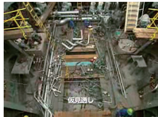
図-4.15 仮見透しの基準点
