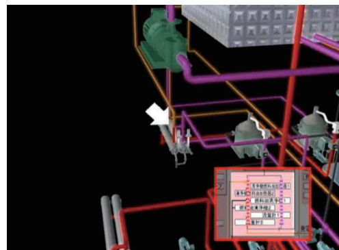
図－2.25 配管経路の検討における検討例② (例：配管経路の迂回)
