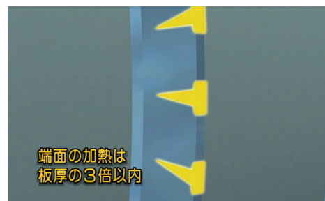
図－3.13 骨材への三角焼き
