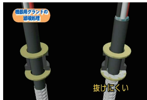
図－5.18 機器用グラントの先端処理
