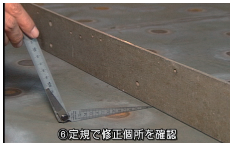
図－3.9 歪の計測及び道具
