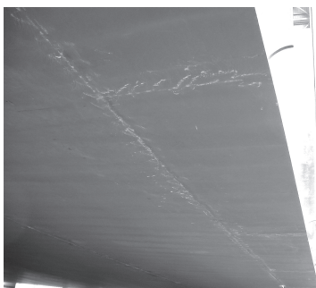
図-3.2 ブロック継手直近の背焼きの跡
