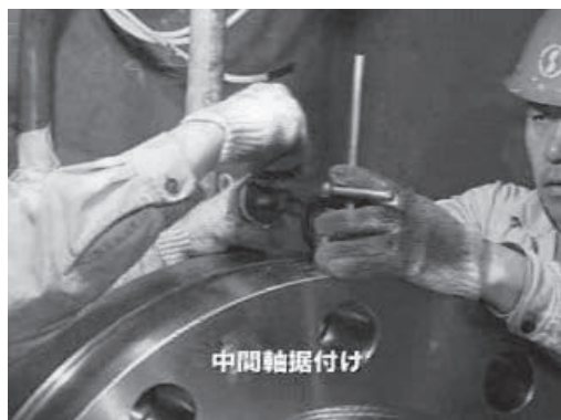
図-4.5 プロペラ軸と中間軸の面合わせ
