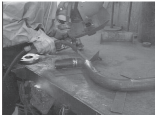
図-2.5 溶接による組立
