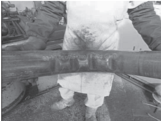
図-2.10 パイプベンダによる曲げの失敗例
