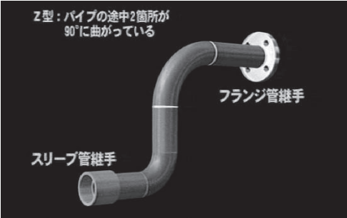
図－2.7 製作する管一品の形状
