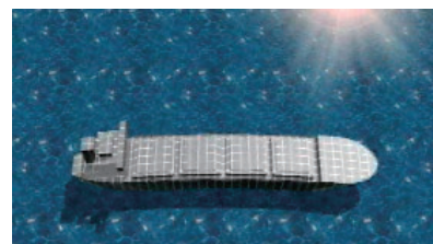
図-4.10 日光による船体の横曲がり
