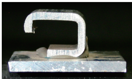
(a) 試験前（板に接着した状況）
