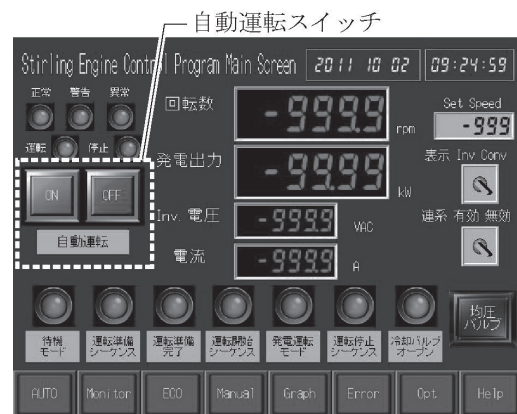
図-6.3 PLC のモニタ画面
