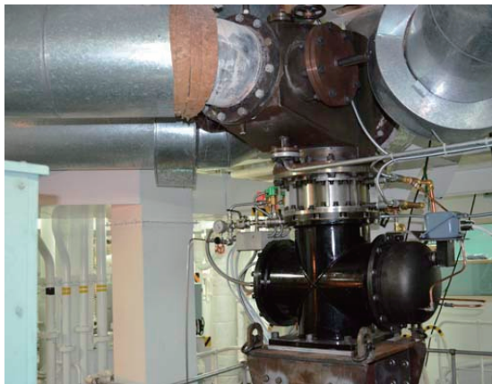
図-6.5 電気推進船に搭載した排熱利用スターリングエンジン
