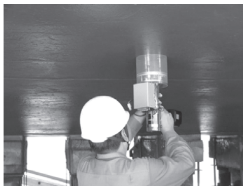
図-1 試作したサンプリング装置による試料採取実験
