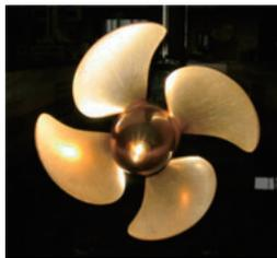
図-6.24 供試模型プロペラ ( $D_p=270$ mm)<sup>16)</sup>
