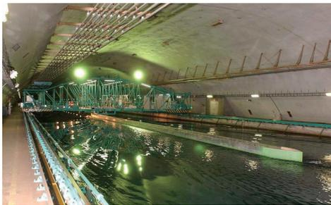
図-6.1 水槽試験中の50m長尺平板模型船<sup>10)</sup>
