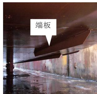
図-6.33 設置された端板(左舷側)<sup>20)</sup>
