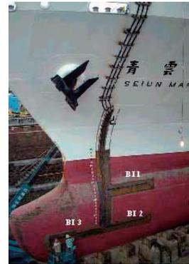
図-3.1「青雲丸」船首に設置された気泡発生装置<sup>5)</sup>
