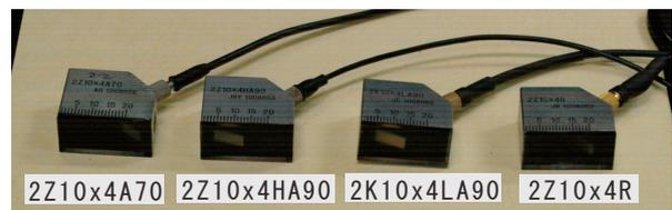
図-3.7 圧電素子を組み込んだ探触子
