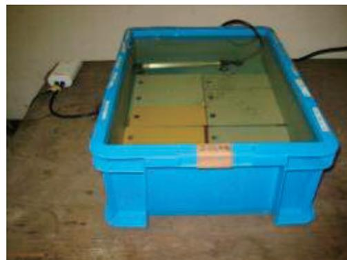
図 1-2  $NaClO$  暴露容器 (左) および対照区 (人工海水) 暴露水槽の外観
