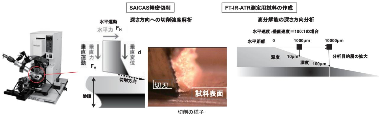
図 5 SAICAS 精密切断および FT-IR-ATR 測定面について
