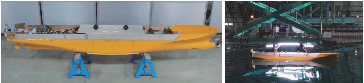
図7 波浪中速力試験の供試コンテナ模型船（左：外観，右：規則波中自走の様子）
