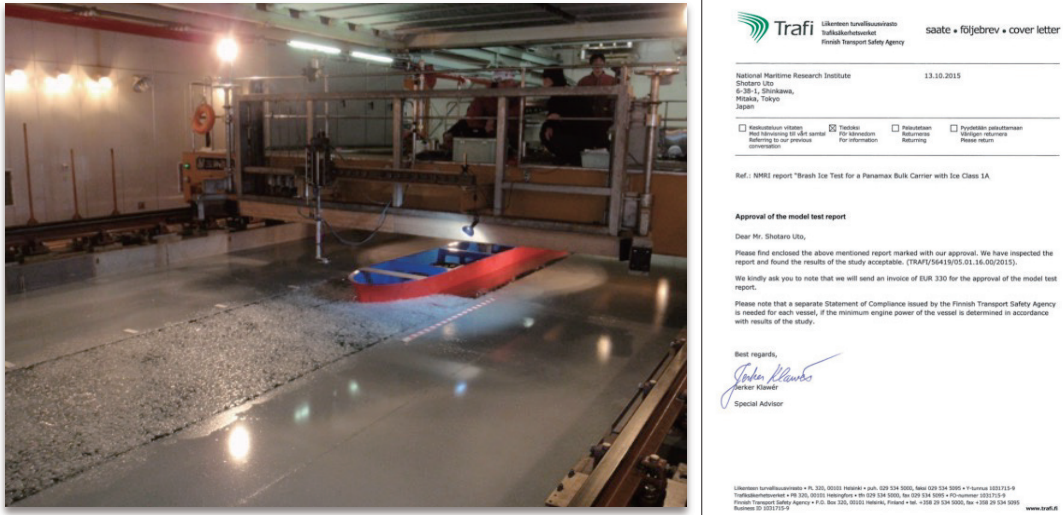
図6-11 バルト海用規則に基づく出力推定試験(NMRI) (左：流水中試験の様子，右：Trafí（フィンランド運輸省）より取得した証書）
