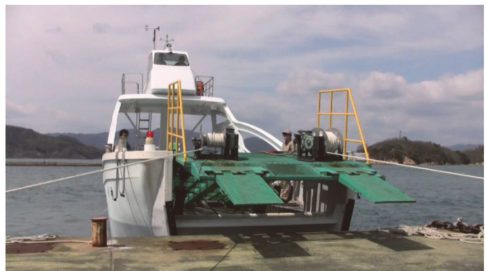
図 4.9 係船作業支援システムの海上試験
