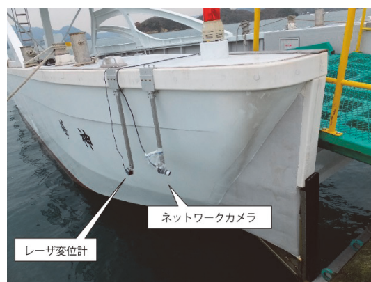
図 4.4 船首部に取り付けたネットワークカメラとレーザ変位計
