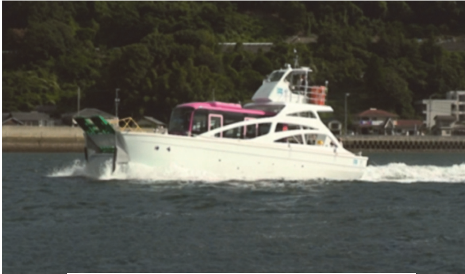
写真1 小型バスを搭載したシームレス実験船
