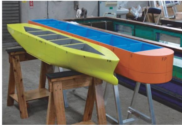
図 2.6 供試模型船（右：FLNG，左：LNG 運搬船）
