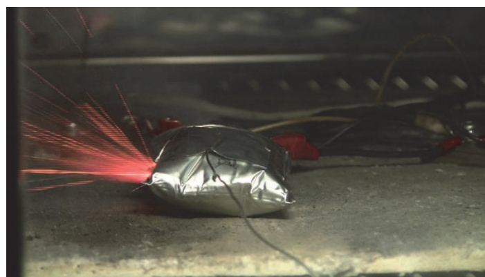
図7 過充電試験によって発火している電池セル
