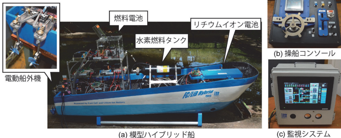
図10 模型ハイブリッド船、タッチディスプレイおよび操船コンソールの外観
