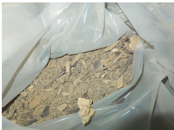
(a) 反応器後流部に堆積していた触媒の破片
