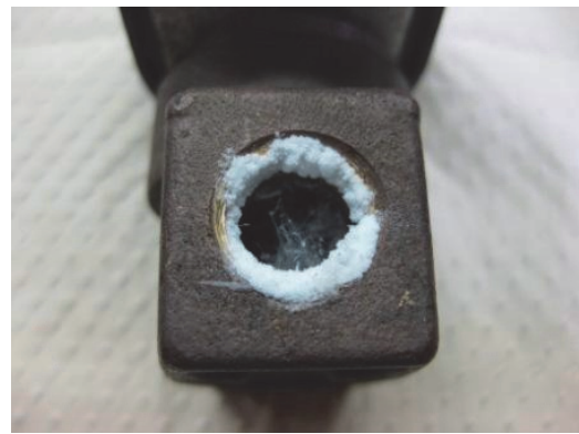
(b) 電磁バルブ入口側の析出物 (2012 年 8 月)
