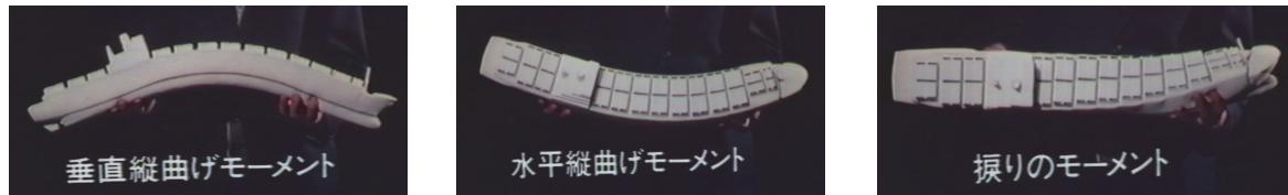
図6 垂直縦曲げモーメント，水平縦曲げモーメント及び振りのモーメント 16)
