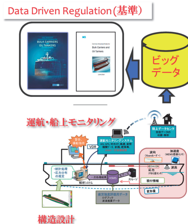
図 28 Data Driven Regulation, 構造設計及び船上モニタリングのリンクの概念図 61)
