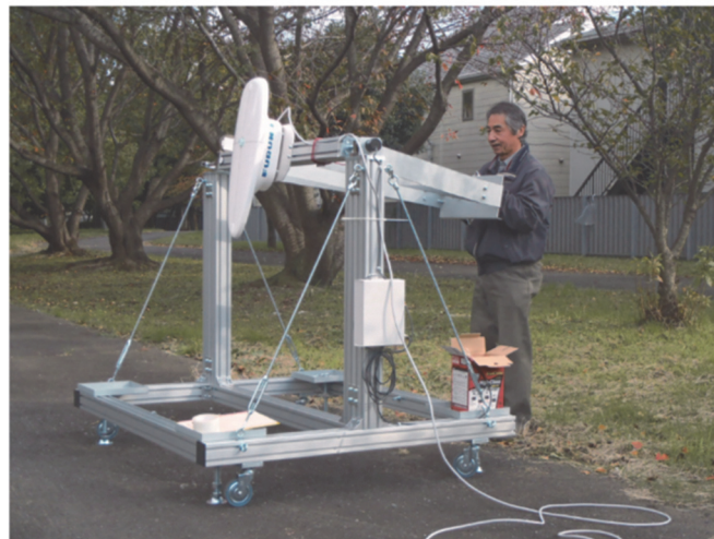
写真2 GPSコンパス用可搬型傾斜角計測装置
