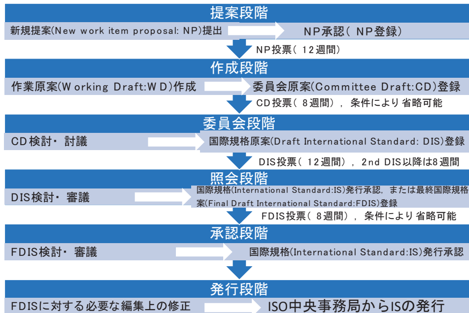
図5 国際標準発行までのプロセスの概要 [19]
