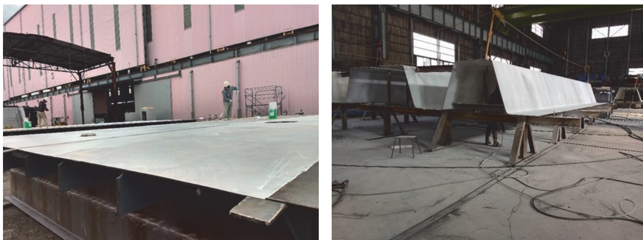
図 4.4 ステンレス鋼材ノンスパッター剤塗布（写真提供：B 社）
