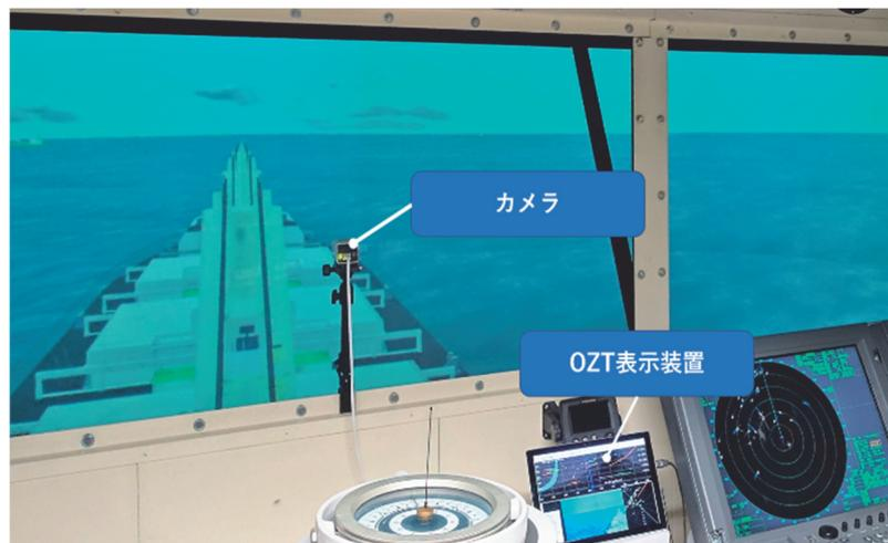
図4 OZT表示装置設置図
