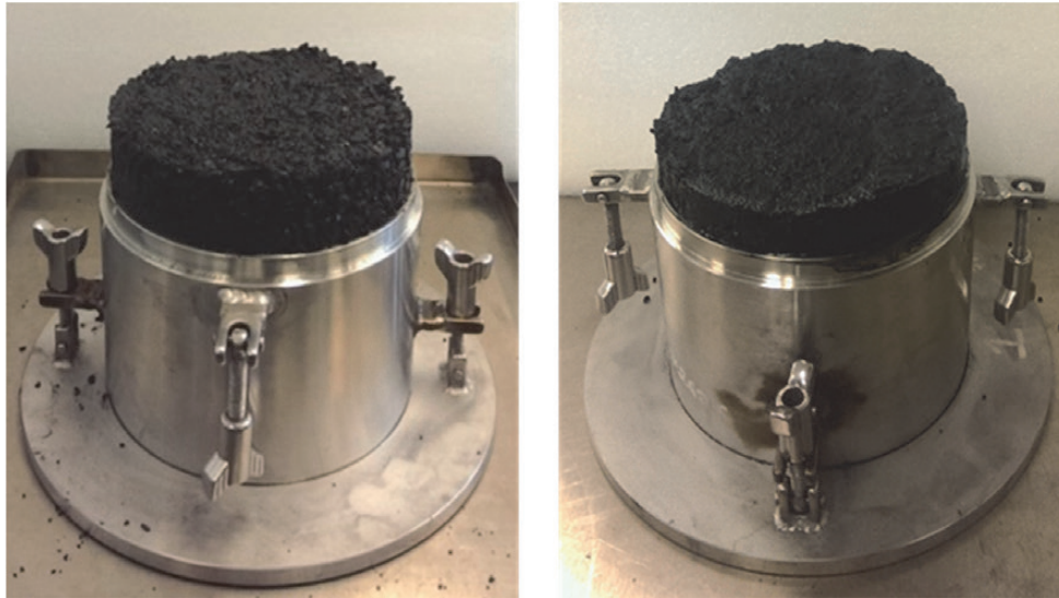
図 1.5.5.3.4.1 部分的に飽和した測定試料（左）とほぼ完全に飽和した測定試料（右）の有効な試験を示す写真
