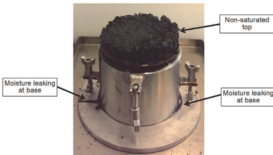
図 1.5.5.3.4.2 円筒形のモールド底面からの水漏れがあり（試料内部における）水分の移動を示す試験
