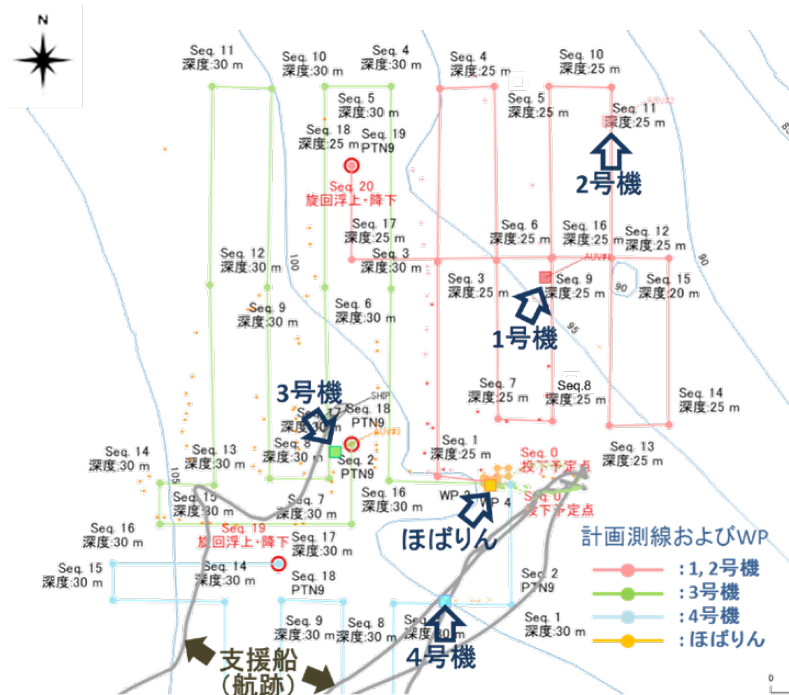
図6 AUV 5機同時運用時の計画測線、WP及び音響測位で捉えた各機の現在位置。
