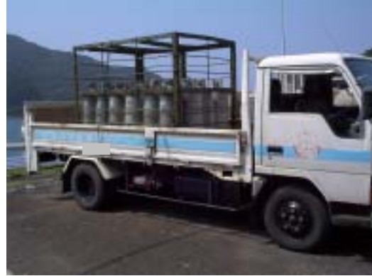
付図 1 4 LPG ボンベ運搬トラック
