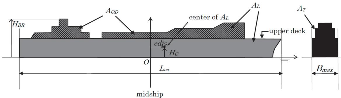
Fig. 12 Superstructure parameters
