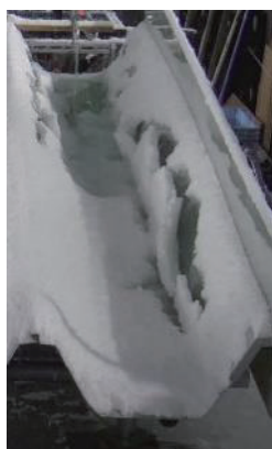
図 8 水換算 10mm 積雪後に散水してから 2 分半後の様子
