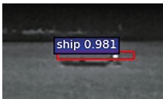
図 8 船体温度が海面温度より低い場合の遠赤外線画像からの検出例
