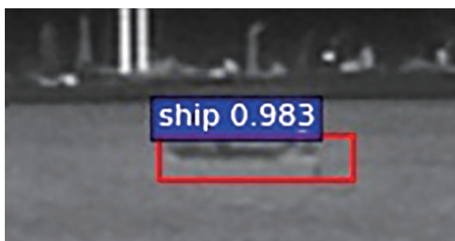
図 8 船体温度が海面温度より低い場合の遠赤外線画像からの検出例
