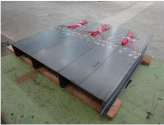
図5 溶接残留応力評価用試験体の外観
