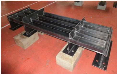
図2 防撓パネル試験体の外観
