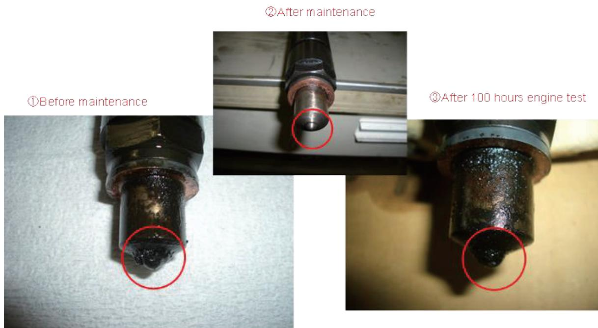
図 19 燃料噴射ノズルの状況 (B30 を用いた耐久性試験)
