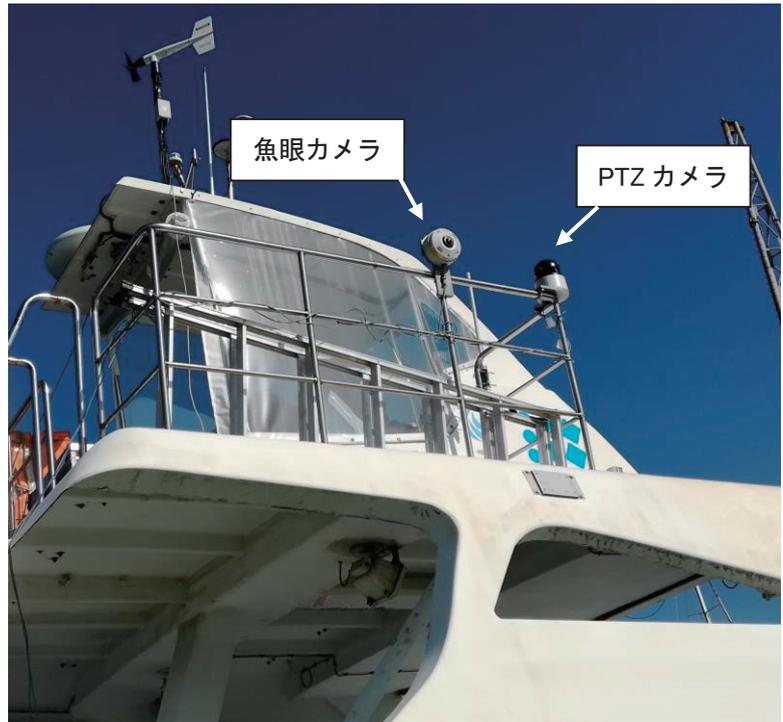
図1 カメラ設置状況 (右舷側. 左舷側も同様)
