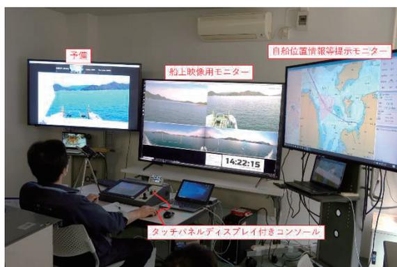
図 3 遠隔制御センターの構成 (文献<sup>11)</sup>より翻訳のうえ引用)
